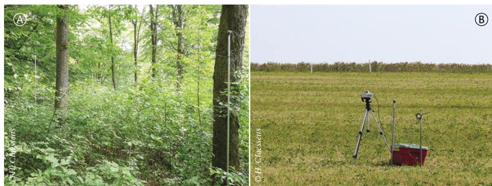
Figure 5 – Mesure de l'éclairement relatif à l'aide de capteurs photosensibles. L'éclairement relatif correspond au rapport entre la mesure de l'éclairement sous la canopée (a) et l'éclairement en plein découvert (b). Vu la difficulté de mesurer l'éclairement au-dessus de la canopée, il est mesuré à proximité en plein découvert.
